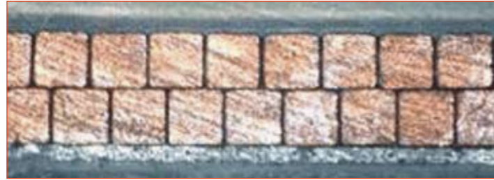
Querschnitt durch eine mit Profildraht bewickelte Spule
